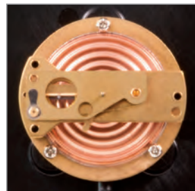
Diafragma de berilio-cobre Diafragma de cobre-berílio
